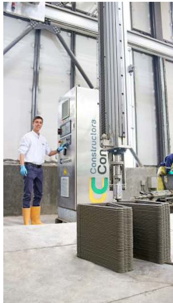
Fabricación de bancas con geometrías complejas en impresora 3D Concreto. Envigado, Antioquia.
