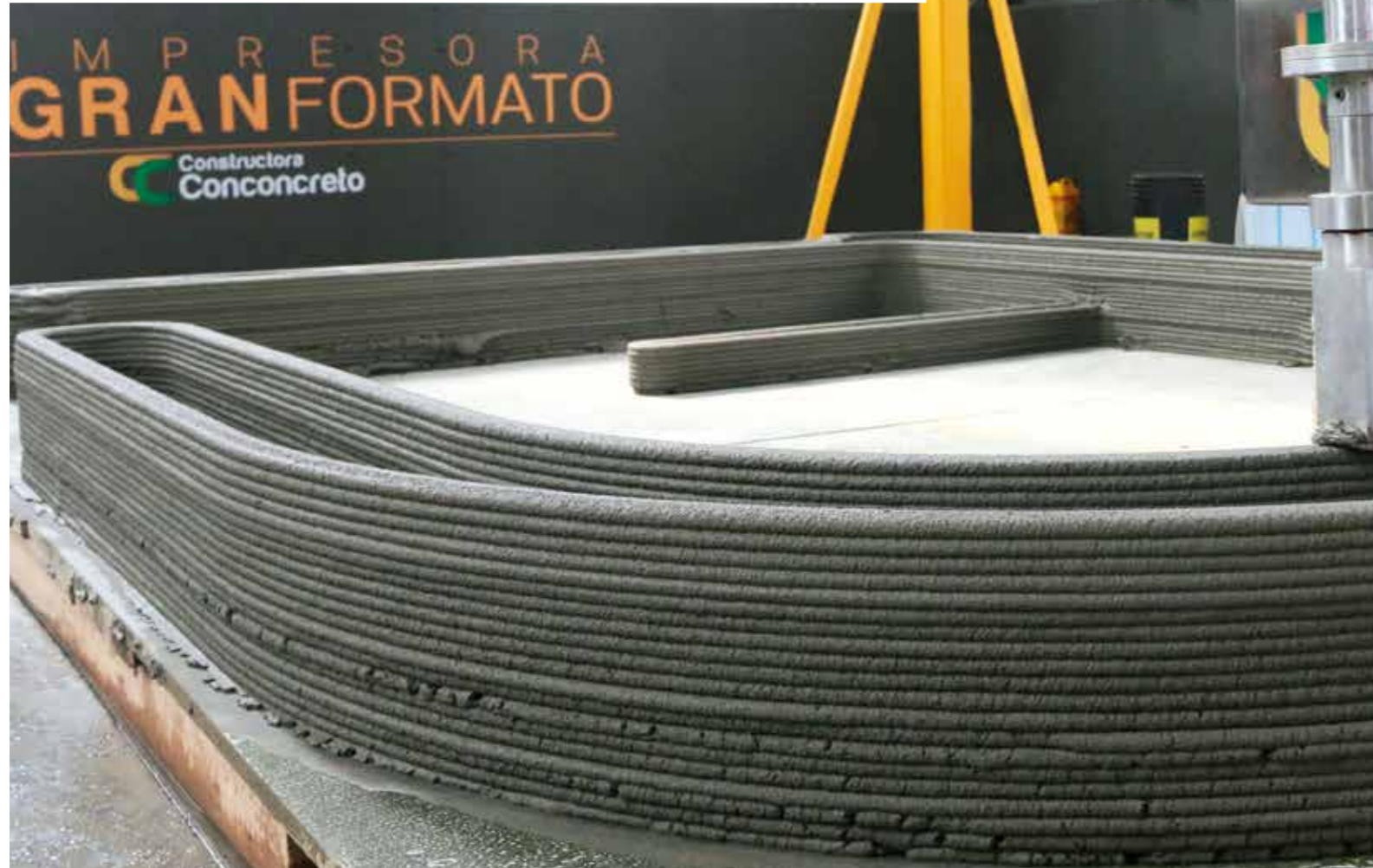
Impresora Concreto 3D gran formato, Centro de Innovación Concreto, Universidad EIA.
