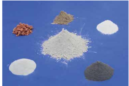
Figura 2.8. Algunas adiciones empleadas en el cemento †
