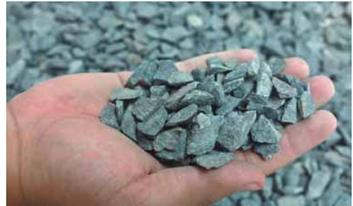
Figura 3.2. Grava procedente de la trituración de agregados naturales †
