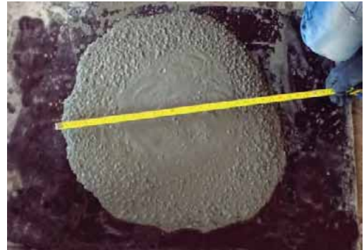
Figura 7.4. Ensayo de flujo de asentamiento (Slump Flow) †
