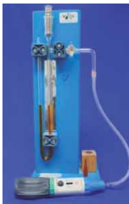
Figura 2.14. Permeabilímetro de Blaine (izquierda), método de tamizado (derecha) †
