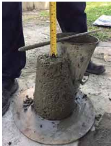
Figura 1.3. Ensayo de Asentamiento o del Cono de Abrams para medir la trabajabilidad en un concreto liviano †
