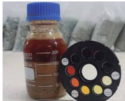
Figura 3.21. Método colorimétrico para detectar la presencia de materia orgánica en la arena †
