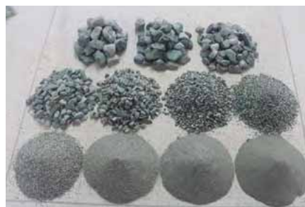
Figura 3.6. Buena granulometría de una masa de agregados para concreto †
