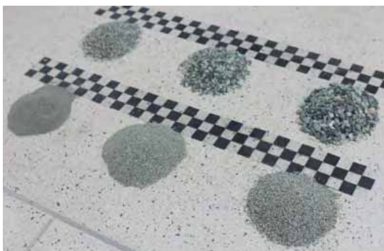
Figura 3.10. Partículas retenidas en los diferentes tamices en un proceso de tamizado †
