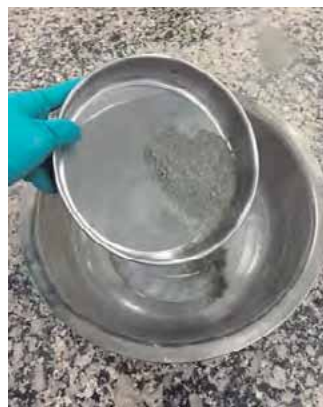
Figura 2.14. Permeabilímetro de Blaine (izquierda), método de tamizado (derecha) †
