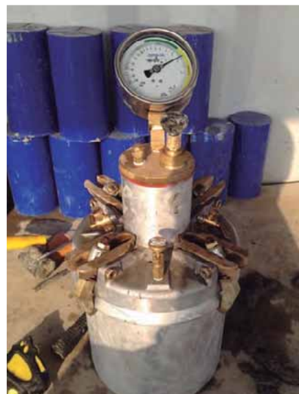
Figura 5.7. Recipiente de medida del contenido de aire. Método de Presión †
