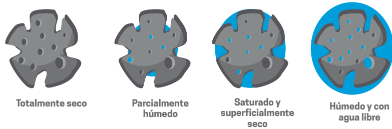
Figura 3.17. Estados de humedad de los agregados*
