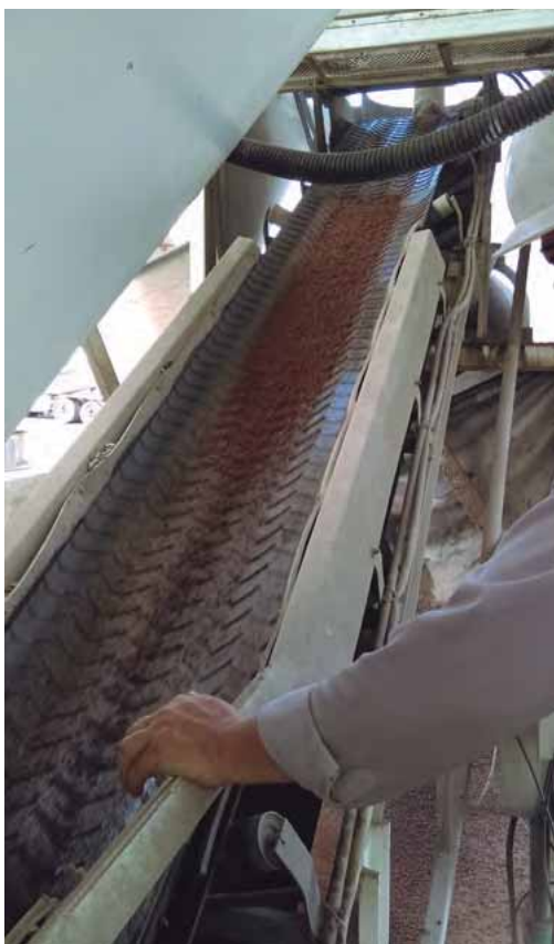
Figura 11.26. Detalle de bandas transportadora arriba: construcción Porce II abajo: en una planta de mezcla
