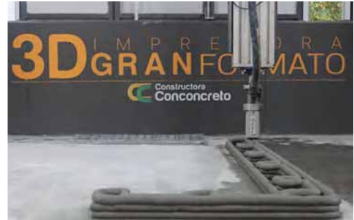
Figura 9.24. Boquilla impresora 3D de concreto gran formato Laboratorio de innovación de Constructora Concreto †
