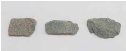
Figura 3.14. Ejemplos de partículas lajudas
