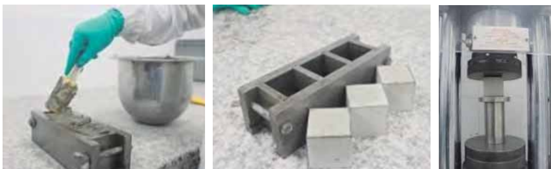
Figura 2.20. Elaboración y ensayo de probetas empleadas en la determinación de la resistencia del cemento †
