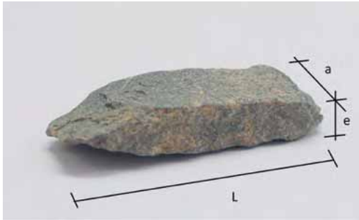
Figura 3.13. Esquema de una Partícula larga y plana
