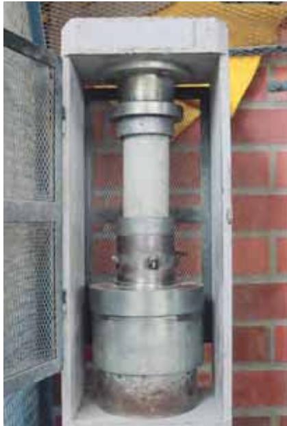
Figura 1.5. Medida de la resistencia a la compresión del concreto mediante probetas cilíndricas †
