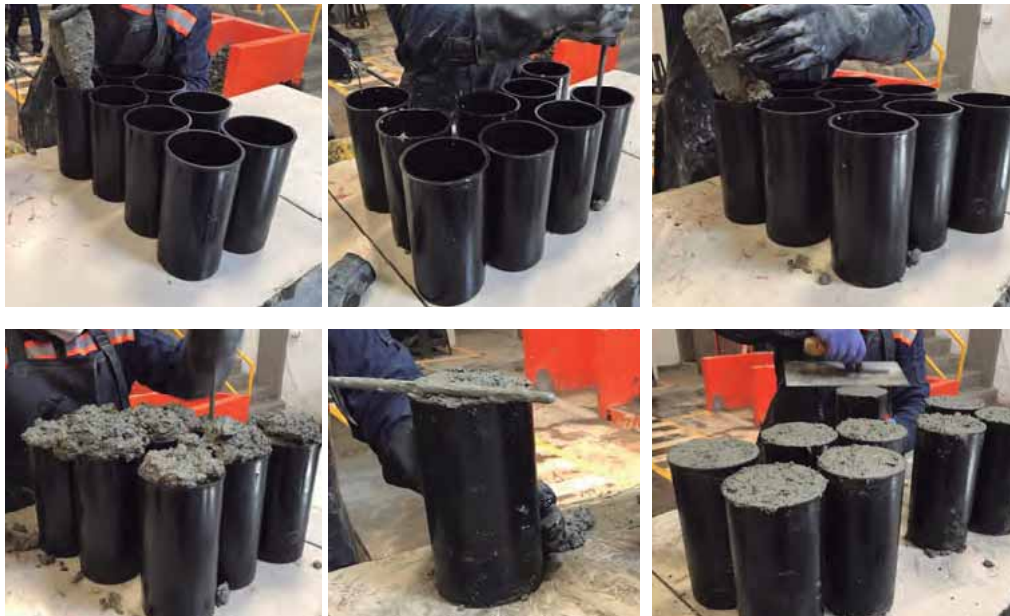
Figura 7.14. Elaboración de probetas cilíndricas †
