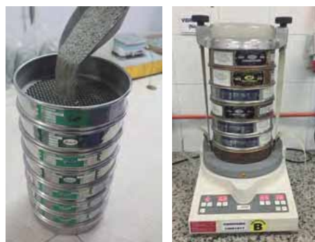
Figura 3.7. Procedimiento de tamizado †
