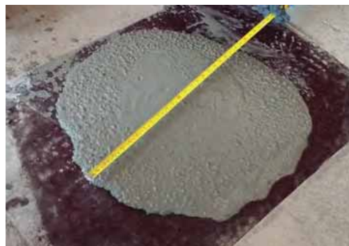
Figura 9.4. Prueba "Slump Flow" o de Flujo
