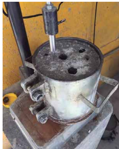
Figura 7.9. Equipo digital para medir el tiempo de fraguado del concreto †
