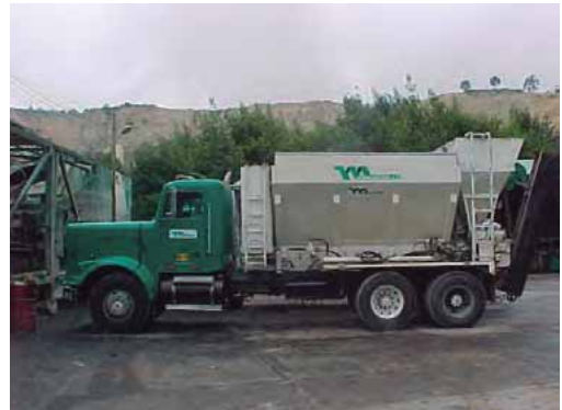
Figura 11.9. Camión productor de concreto +
