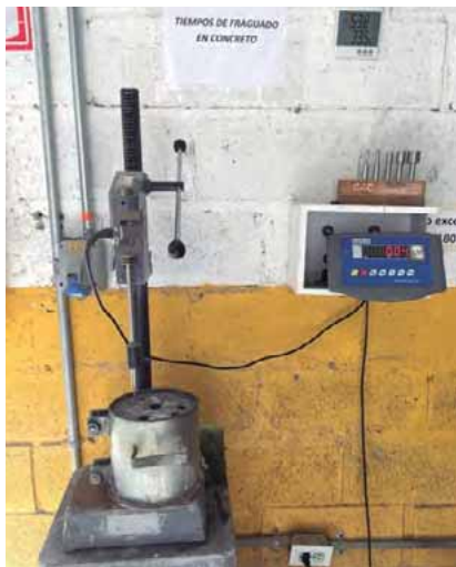
Figura 7.9. Equipo digital para medir el tiempo de fraguado del concreto †
