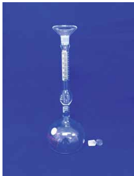
Figura 2.13. Frasco de Le Chatelier para medir el peso específico del cemento †
