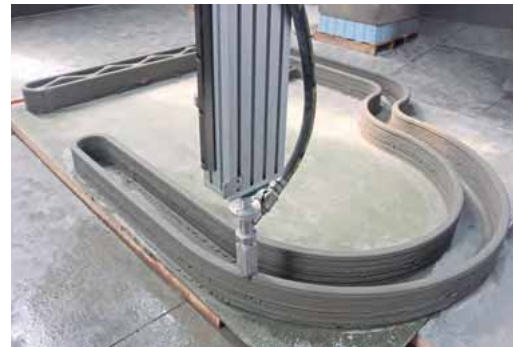
Figura 9.25. Impresión en 3D gran formato Laboratorio de innovación de Constructora Concreto †
